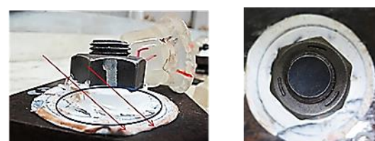
図 12 ボルトキャップ内部
