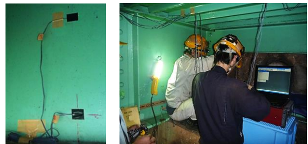
(a) ひずみゲージ (b) 動ひずみ計を用いた計測
