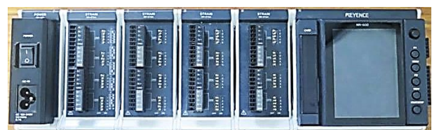
写真 4 動ひずみ計(NR-600)
