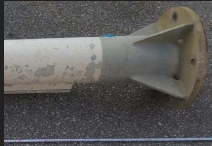
リブ有照明柱
