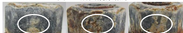
左:① 中:④ 右:⑤ 複合サイクル試験 (648 時間経過) 写真 2 腐食促進結果
