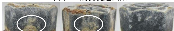
左:① 中:② 右:③ 複合サイクル試験 (648 時間経過) 写真 3 腐食促進結果
