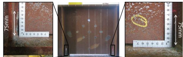
(a) 腐食試験体
