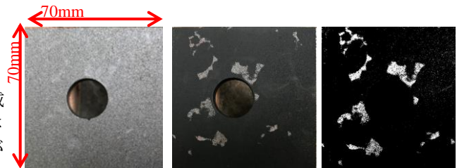
(a)塗料未使用 (b)塗料使用 (c)二値化処理
