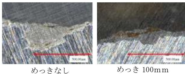
写真-2 試験体断面 (境界部)
