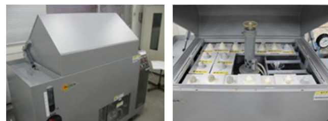
写真 2.2a 左: 塩水噴霧機 右: 設置状況
