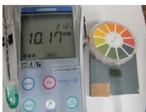
写真6 pH試験紙とpHメータの比較
