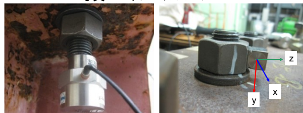
(a) 縦方向の振動計測 (b) 横方向の振動計測
