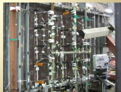
変位計の設置状況
