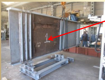
写真1 大型I桁試験体
