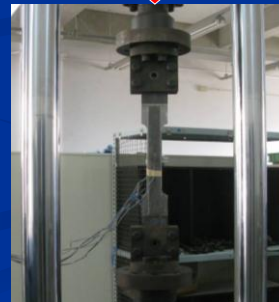
写真1 200kN疲労試験機
