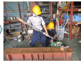
3. 抜いた時のひずみが出るまでナットを締める
