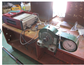
2. ナットを緩めひずみを計測する
