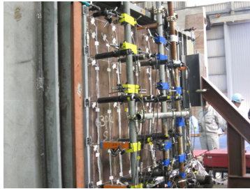
変位計、ひずみゲージ設置状況
