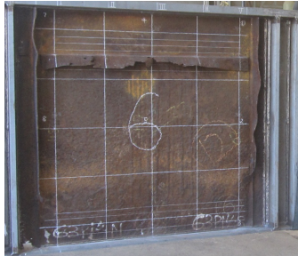
試験体3(中央から下部が腐食)
