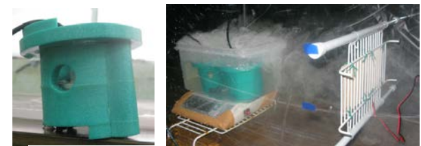
写真3 超音波霧化ユニットとミスト発生状況
