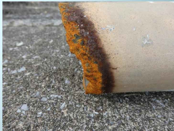
破壊部の腐食減肉。
