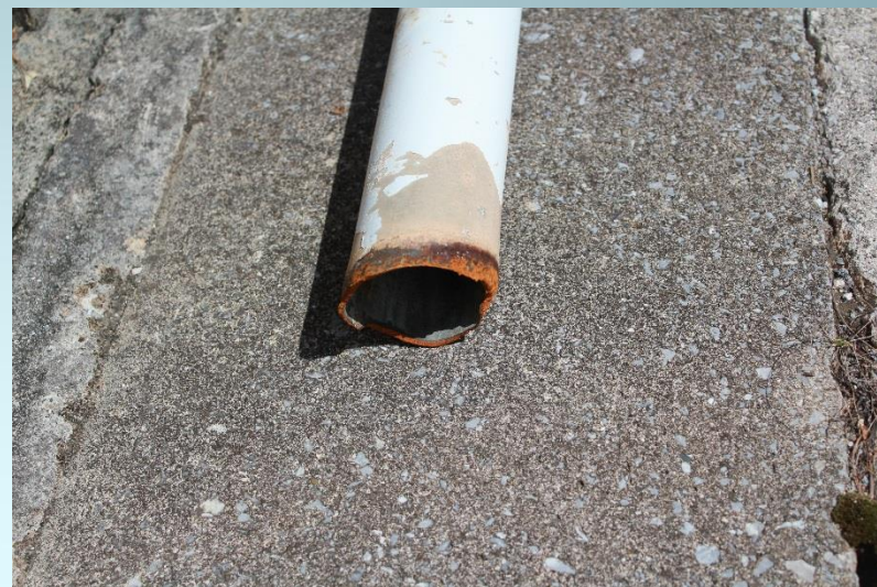
破壊部の腐食減肉。
