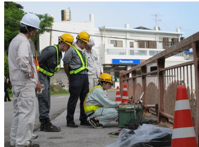
利光くん動ひずみ計の動作確認中
